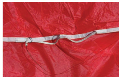
Le mouflage de frein en plume donne une manœuvrabilité efficace à cette machine.
